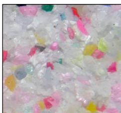
Resina termoplástica acrílica, adecuada para limpieza suave y decapado de superficies de metales no férricos y de componentes electrónicos.
