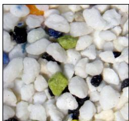
Resina plástica termoestable, **Urea (Tipo II)** curada, molida, clasificada y tratada con soluciones antiestáticas. Los niveles de polvo son extremadamente bajos (inferiores al 1%) - las US MIL. Spec. estipulan 5% o menos.
