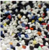
Resina plástica termoestable (urea o melamina) curada, molida, clasificada y tratada con soluciones antiestáticas. Los niveles de polvo son extremadamente bajos, inferiores al 1% respecto al 5% que exigen como máximo la Norma MIL-P-85891A entre otras. Sus granos angulares son más agresivos que los de las granallas vegetales. No produce desgaste alguno en los equipos de proyección y no afecta al sustrato de la superficie de la pieza a tratar.
