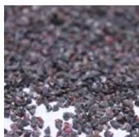
Corindón marrón de máxima calidad, destaca por su alta pureza (>96% de alúmina), tenacidad y dureza, y su resistencia y durabilidad. Granos de formas angulares. Exento de sílice libre.
