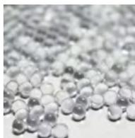
Vidrio químicamente neutro, no poroso y sin sílice libre. Rango de esfericidad superior al 97%. Adecuado para trabajos en seco y húmedo, sin erosión medible, de la pieza tratada.
