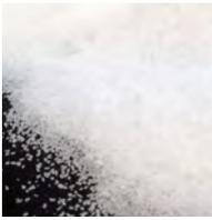
Bicarbonato sódico natural (mineral). Es un abrasivo suave y muy friable que proporciona una acción de limpieza y desengrase única, a la vez que respeta al máximo la superficie tratada.
