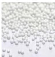
Esferas regulares de un compuesto no poroso a base de Circonia y una fase vítrea de Sílice que le otorga de una elevada dureza y tenacidad. Aporta mayor durabilidad, más de 60 ciclos respecto a la microesfera de vidrio. Acabados más homogéneos, reducción considerable del consumo debido a su menor índice de rotura. Muy aplicado en salas de chorreado y equipos de granallado automáticos.
