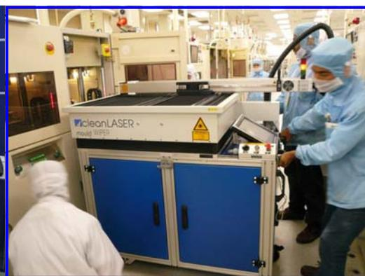
*Sistema "moldWIPER" para la limpieza de delicados moldes en la industria de semiconductores*
