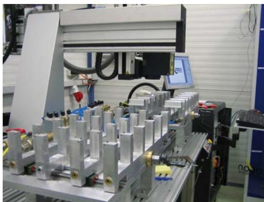
*Sistema de fijación y desplazamiento de la pieza hecho a medida*
