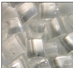
Granulados procedentes de la extrusión de Policarbonato de alta densidad. El *tipo general* es adecuado para cualquier aplicación de chorreado y posee bajos índices de rotura, lo cual le confiere una larga vida. El *tipo criogénico* está formulado a partir de policarbonato puro de elevada viscosidad, para aumentar la densidad y duración en las aplicaciones criogénicas. Puede trabajar a temperaturas de hasta -196°C.
